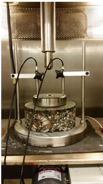
Figur 4 Utrustning för bestämning av dynamisk krypstabilitet (Foto: B.R. Nilsson)
